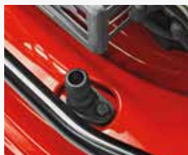
Slangaansluiting met speciale sproeikop
