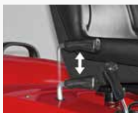
Gepatenteerd ontstoppingssysteem rijdend te bedienen
