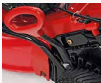
Centrale maaihoogte-instelling met comfortabele hendel
