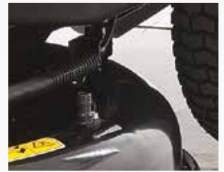
Slangaansluitstuk voor eenvoudig reinigen van het maaidek
